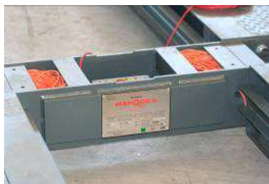
- Viga transversal central montada con módulos metálicos. Podemos ver los cables de conexión de las células.
