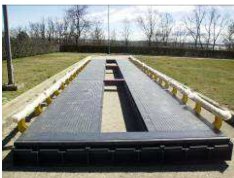
- Báscula puente PCM SG sobresuelo construida con módulos metálicos.
